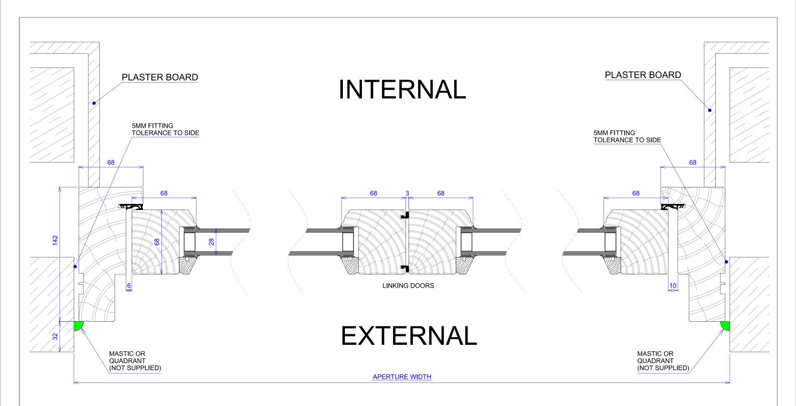
THE DOORS SHOWN ARE ODD AND ALL STACK TO THE LEFT (NO RIGHT DOORS). IF THE DOORS ALL STACKED TO THE RIGHT THE LARGER 10MM GAP WOULD BE THE OPPOSITE HAND TO THOSE ABOVE.
